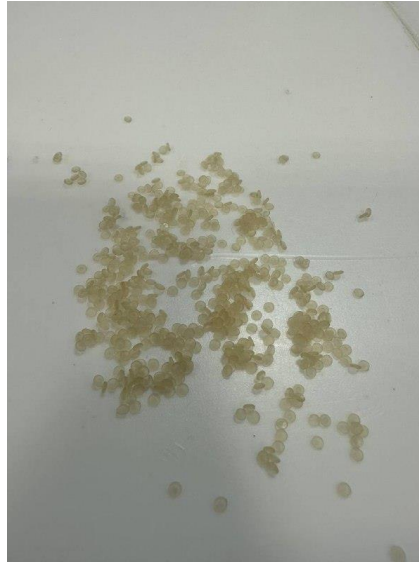
Şekil 2. Kuru katalitik hidrojel küreler
