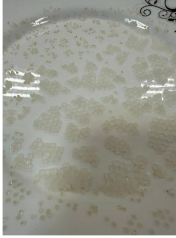
Şekil 1. Nemli katalitik hidrojel küreler
